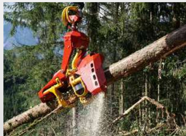
La longitud del cabezal WOODY permite el talado controlado de árboles grandes.
