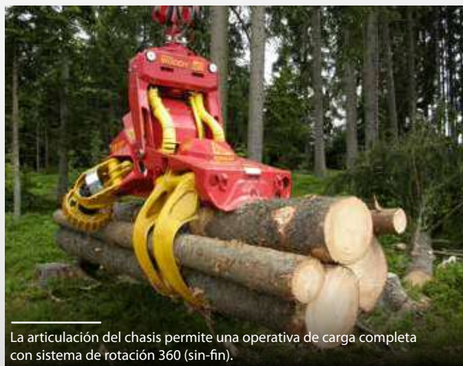
La longitud del cabezal WOODY permite el talado controlado de árboles grandes.
