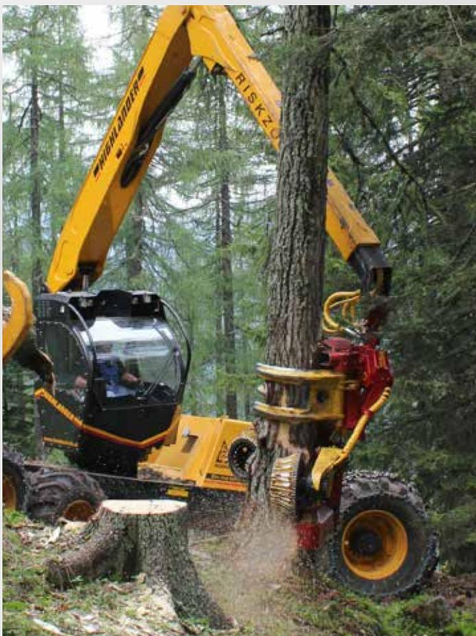
La nueva innovación Highlander es una procesadora de alto rendimiento para maderas duras de tamaño medio. En terrenos normales, la Highlander puede moverse con especial maniobrabilidad. En terrenos inclinados y de difícil acceso, la máquina tiene una enorme flexibilidad debido al sistema sincronizado de paso y empuje. La Highlander auna la capacidad de escalada de las máquinas en cadenas junto con las ventajas de una máquina en ruedas.
